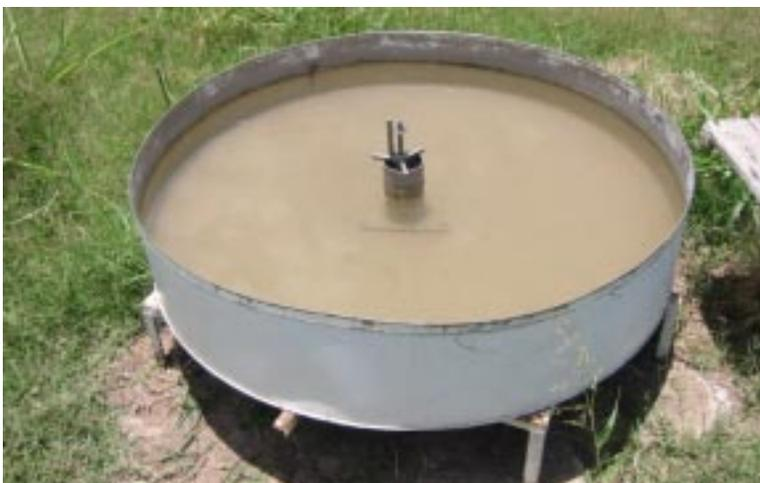
Figura 36. Tanque evaporímetro "A" (1.22 m de diámetro en su base 0.26 m de altura)
